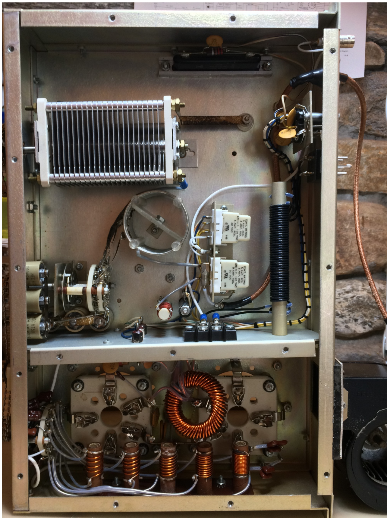
Vista complessiva del telaio inferiore "RF" e del ventilatore per il raffreddamento delle valvole
